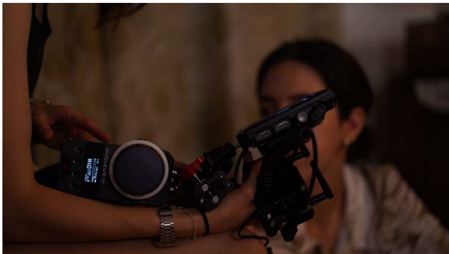
Figura 34. El follow focus Tilta Nucleus-M que se utilizó en el rodaje. Fuente: Elaboración propia.
