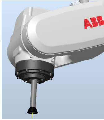
Figura 37. Herramienta ventosa conectada
