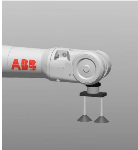
Figura 4.2: Herramienta de doble ventosa
