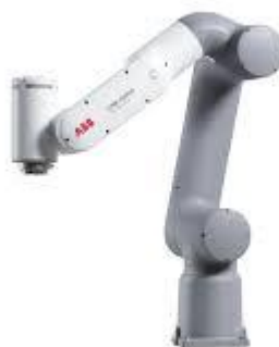
Figura 2.5. Robot colaborativo GoFa de ABB
