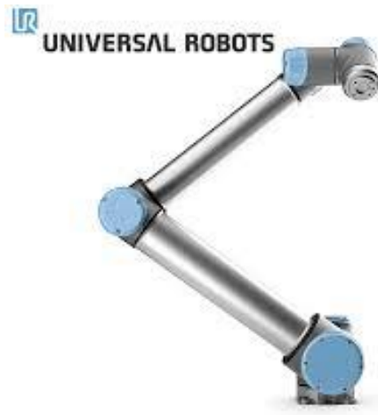
Figura 2.6. Robot UR10e de Universal Robotics
