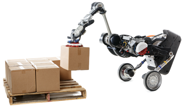
Figura 1-4: Robot Handle diseñado por Boston Dynamics para desempeñar tareas de transporte de cargas.
