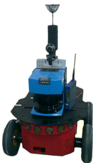
Figura 3-4: Ejemplo de robot móvil autónomo. Robot Pioneer P3-AT equipado con sensores SONAR, Láser 2D y sistema de visión catadióptrico.
