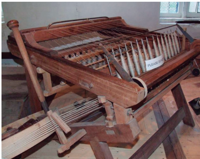
Fig. 1: Màquina de filar "spinning jenny", segons la patent de Hargreaves de 1770.
