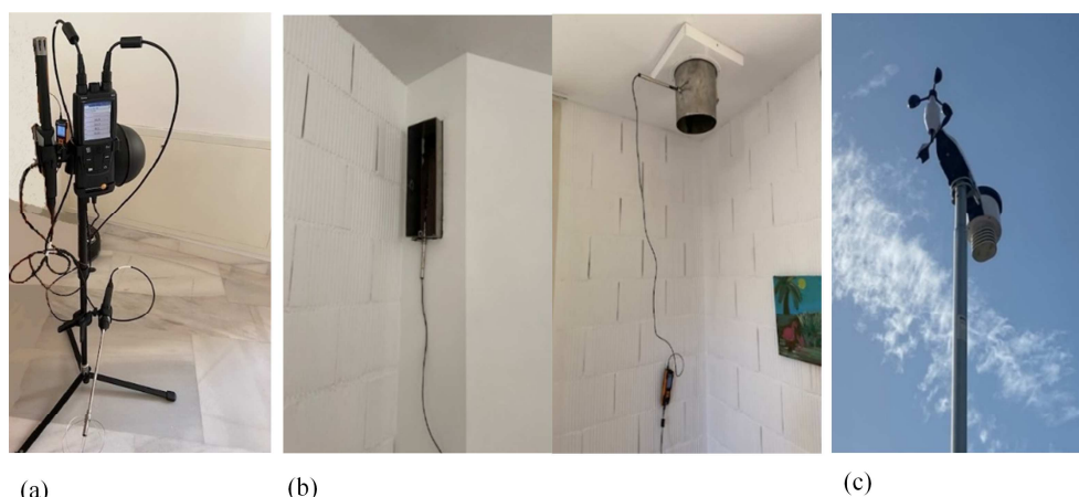
Figura 4. Emplazamiento de los sensores: (a) IAQ; (b) Hilos calientes; (c) Estación meteorológica
