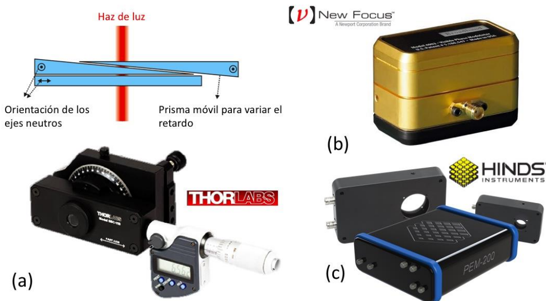
Figura 2.9. Ejemplos de otras tecnologías de retardadores lineales sintonizables: (a) Compensador de Soleil-Babinet, (b) modulador electro-óptico y (c) modulador foto-elástico (imágenes adaptadas de [WIK-web2], [THO-web6], [NEWF-web] y [HIN-web]).
