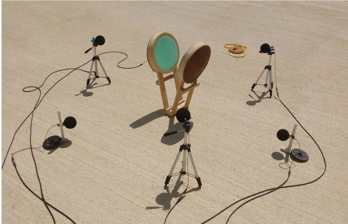
Figura 10. Posicionamiento de micrófonos para ensayo de potencia acústica.
