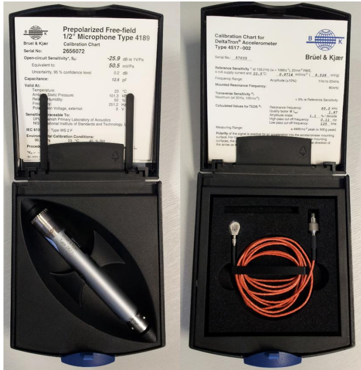
Figura 21. Ejemplo de micrófono y acelerómetro empleados en los ensayos
