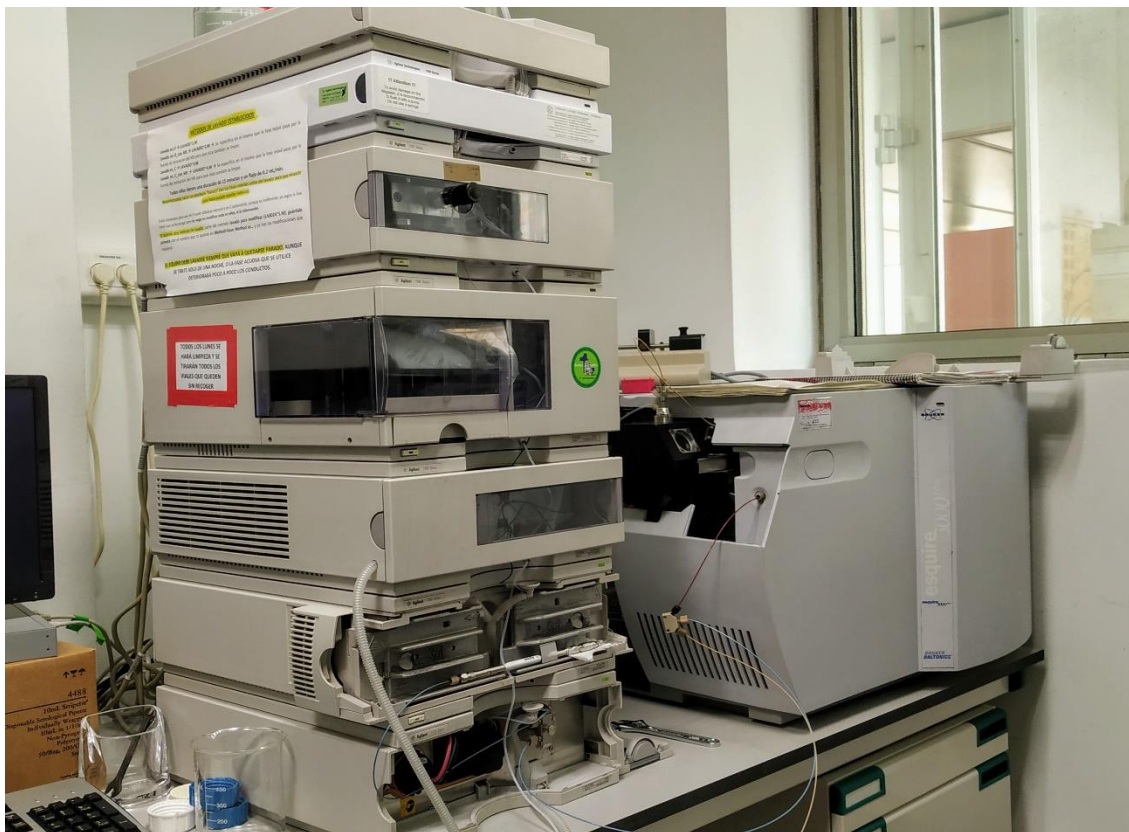
Figura 29. Cromatógrafo Agilent LC 1100 acoplado a un espectrómetro de masas Esquire 3000+ empleado en la caracterización de los extractos empleados en este trabajo.
