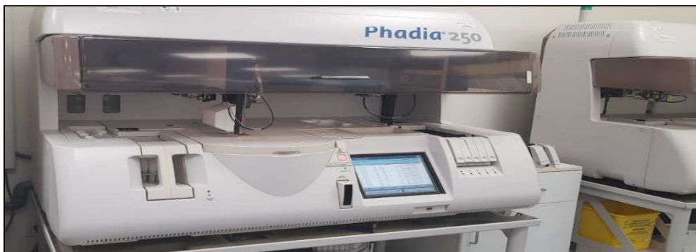
Fig 3: Equipo Phadia 250 para la medida de IgE, IgG e IgG4 específicas a los alérgenos, triptasa y PCE.
