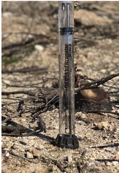
Figura 11. Mini Disk Infiltrometer durante una medición en campo. Foto: Jorge Mataix-Solera (2020).
