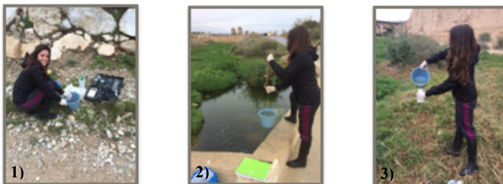
Figura 6. Fotos durante el muestreo. 1) Toma de muestra. 2) Preparación para medida de CE, pH y temperatura de la muestra. 3) Envasado para determinación en laboratorio.
