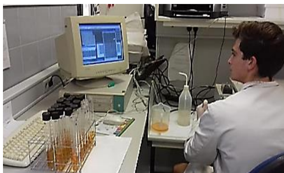
Figura 9. Medición en el espectrofotómetro para la determinación de fósforo.
