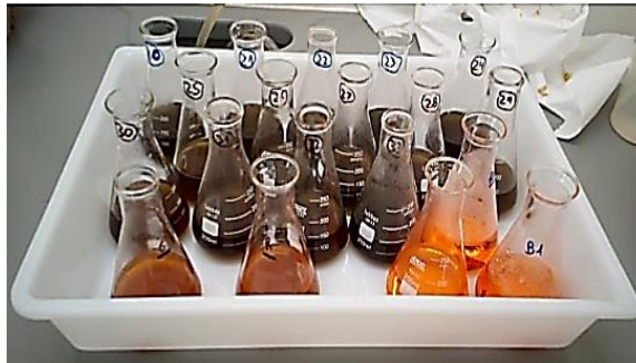
Figura 8. Erlenmeyers con dicromato potásico para su posterior valoración con Sal de Mohr.
