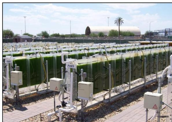
Figura 5. Fotobiorreactores de placa plana (AzCATI).
