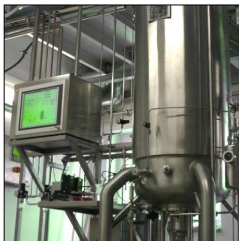
Figura 8. Tanque cerrado o fermentador (Bbi-biotech).
