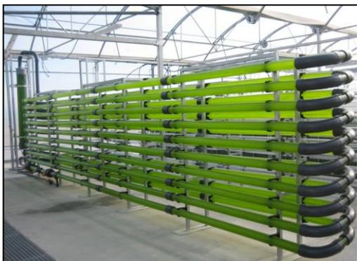
**Figura 6. Fotobiorreactores tubulares cerrados en la Plataforma Tecnológica de Experimentación en Madrid (Algaenergy).**
