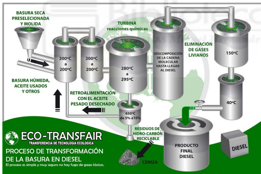
Figura 4: Proceso de transformación de la basura en diésel. Fuente: ECO-TRANSFAIR (2019).
