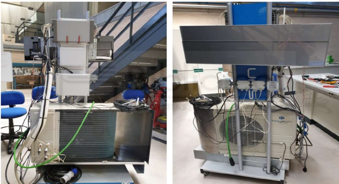
Figura 22. Visión general delantera y trasera del equipo de climatización sin sección evaporativa.
