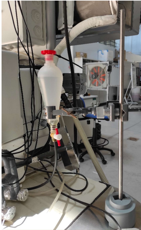
Figura 46. Depósito de la instalación hidráulica.
