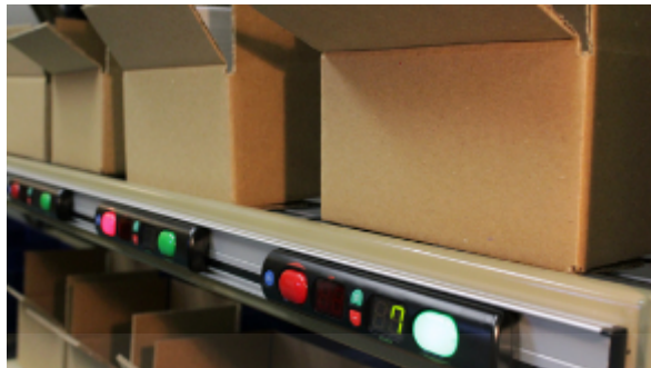
Figura 1.2 Ejemplo de Pick-to-light
