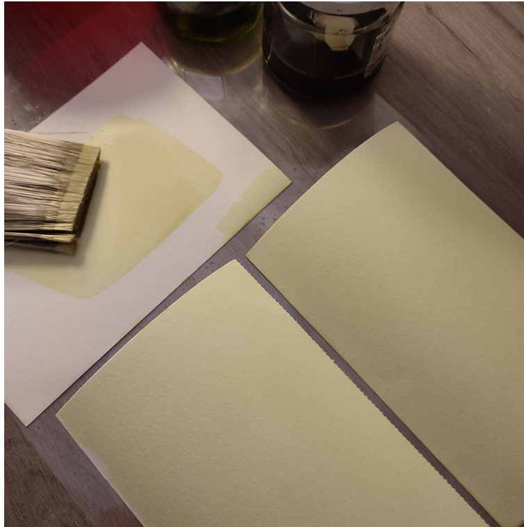
Figura 7. Detalle del proceso de emulsionado del papel.
