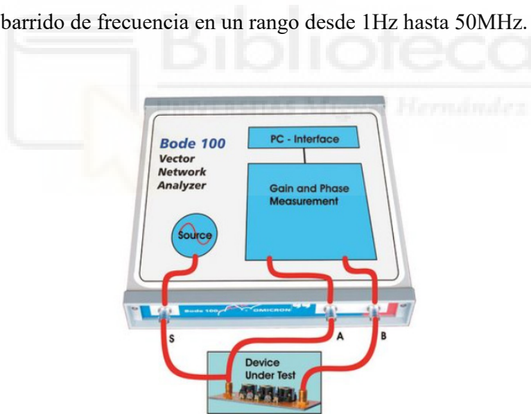
Fig. 9 Esquema conexiones Bode100 [4]
