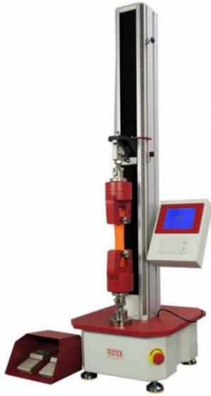
Figura 5.1: ejemplo máquina de tracción.
