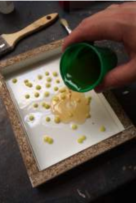
Imagen 132. Vertido resina de poliuretano
