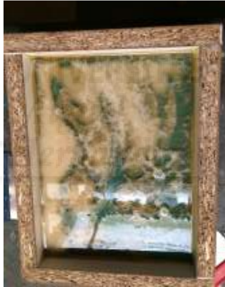
Imagen 187. Curado de la resina de poliuretano.
