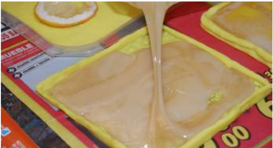
Imagen 126. Vertido de la resina de poliuretano sobre base de plastilina.
