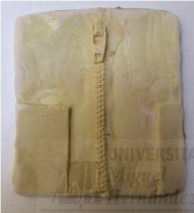
Imagen 128. Matriz final de resina con motivos de cremallera con moldeado
