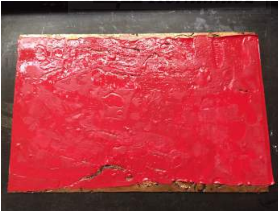
Imagen 113. Proceso de fusión del polivinilo a 70°C.
