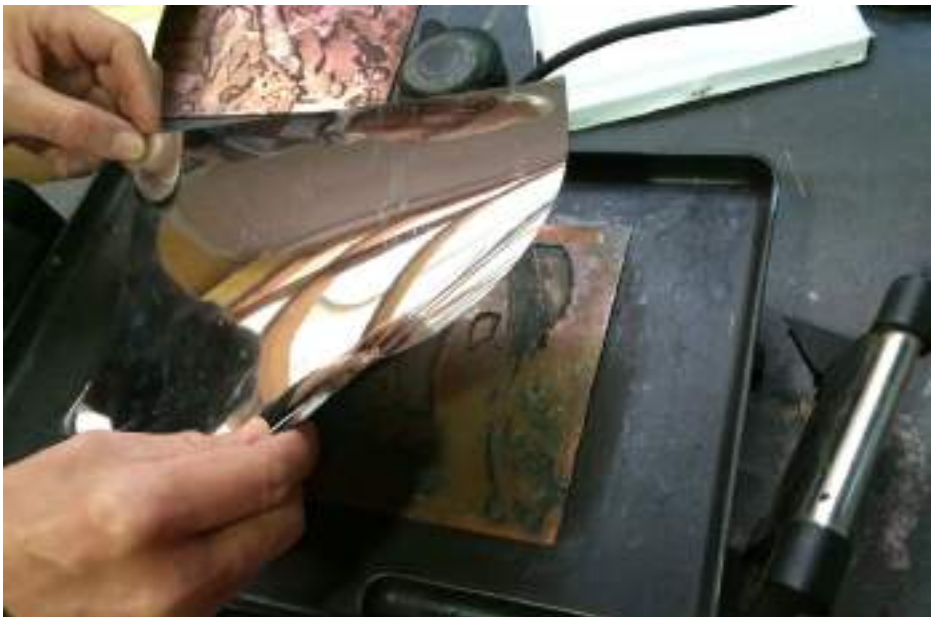
Imagen 107. Lamina de polivinilo depositada sobre matriz cobre a alta temperatura.
