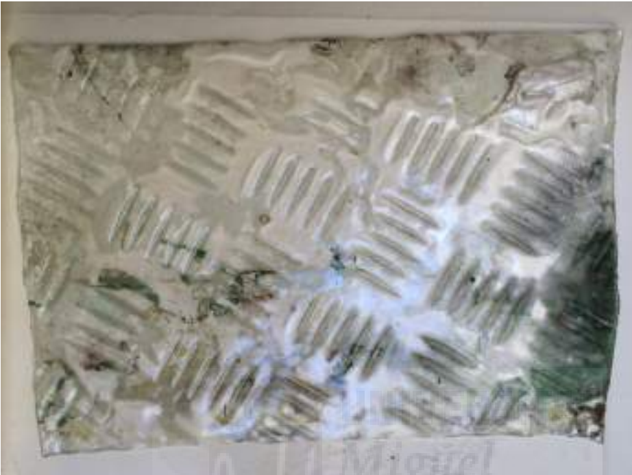
Imagen 90. Plancha de poliestireno realizada sobre suelo de acero dulce
