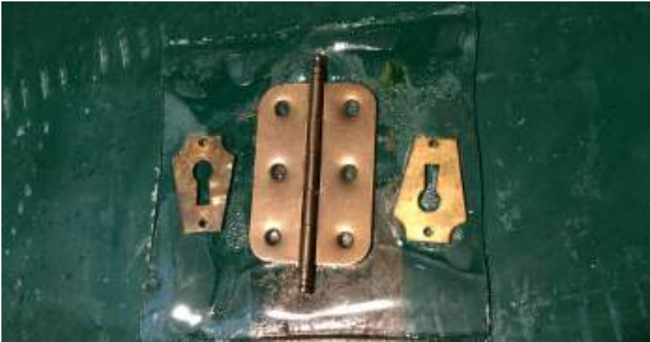
Imagen 91. Plancha de poliestireno sobre plancha de metal y objetos depositados en ella en el proceso de fundición.
