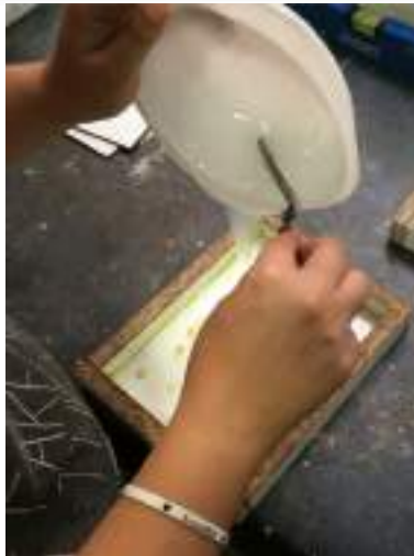
Imagen 157. Vertido de la mezcla del RTV 7002.
