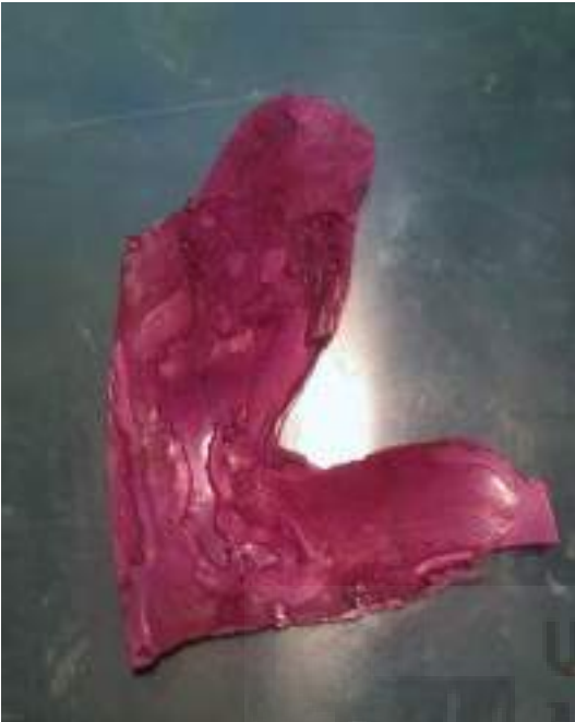
Imagen 106. Motivo de polipropileno reproducido de una matriz de cobre.
