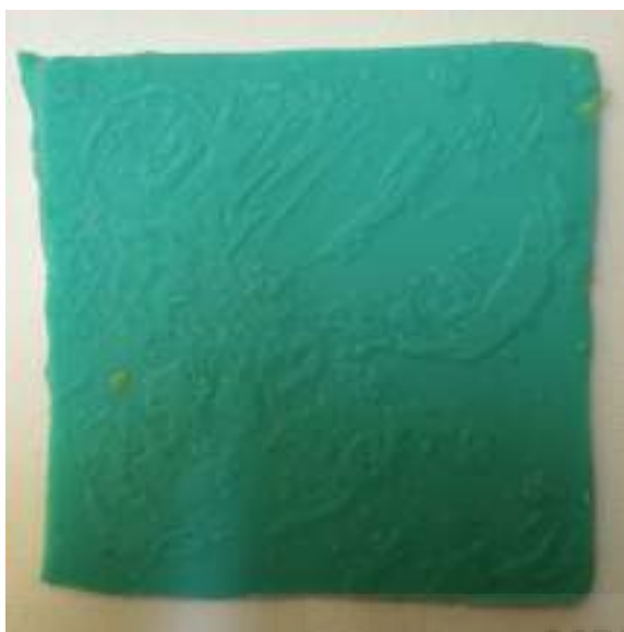
Imagen 153. Matriz final de silicona de reproducción de plancha de metal con hueco-relieve.
