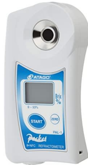
Figura 17. Refractómetro utilizado para medir los sólidos solubles. Fuente: catálogo Atago.
