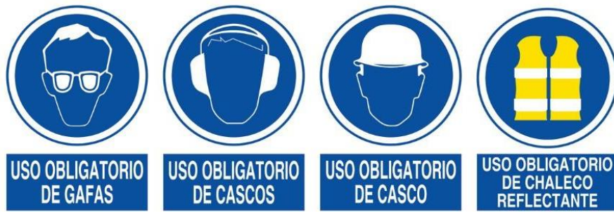
Imagen 2 y 3. Señales de obligación complementarias en la obra. Fuente. Eversign.com
