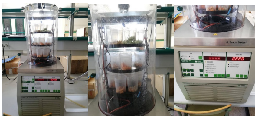
Figura 8: Liofilizador. Cámara seca y condensador con circuito de refrigeración.
