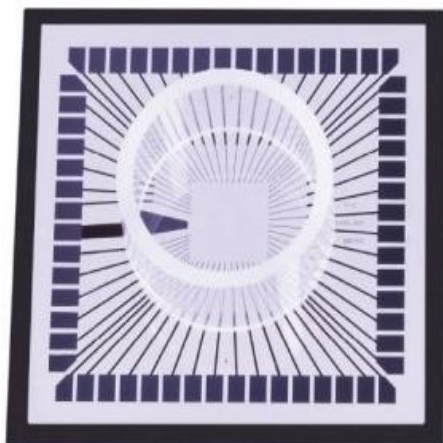
Figura 7 Imagen de la placa de electrodos 60MEA100 (l Multi Channel Systems MCS GmbH, Alemania).
