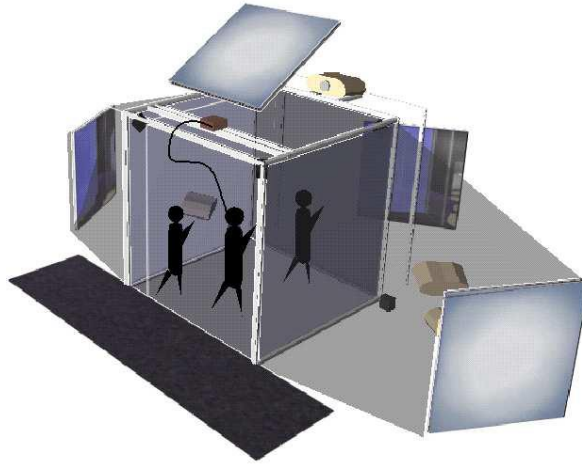
Figura 4: Esquema de una cueva de realidad virtual con uso de proyectores [18].
