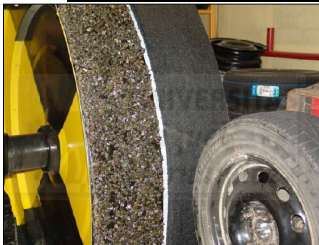
FIGURA 32. Ensayo en rodillo cubierto de réplicas de asfalto [31]
