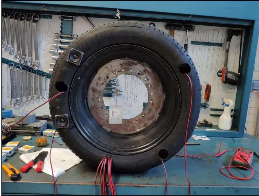
FIGURA 150. Colocación de los cables por el interior del neumático
