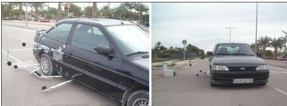
FIGURA 38. Disposición de los micrófonos en el ensayo A-CPX [12]
