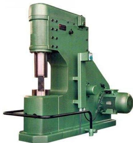
Figura 4: Martinete Autocompresor (Figura 4, s.f.)
