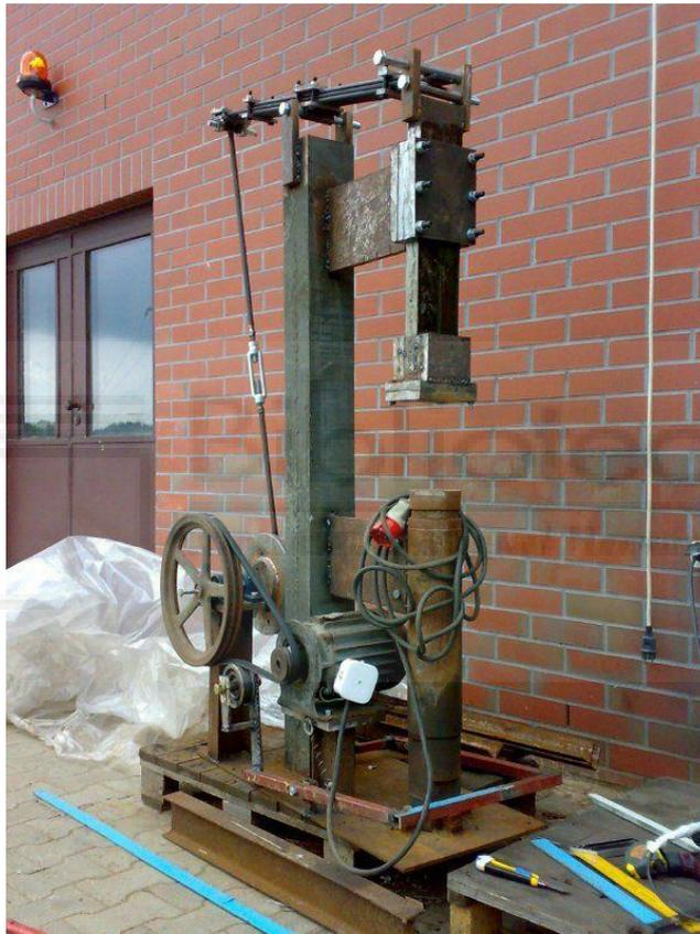
*Figura 10: Martinete mecánico. (Figura 10, s.f.)*
