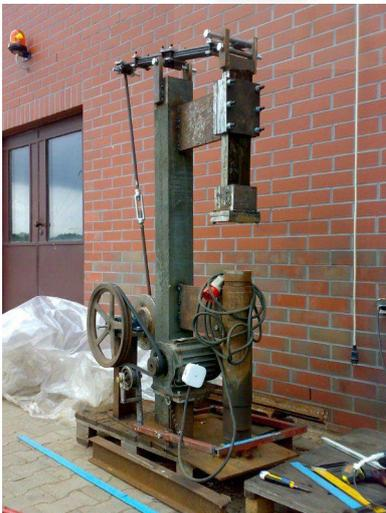
Figura 3: Martinete mecánico. (Figura 3, s.f.)
