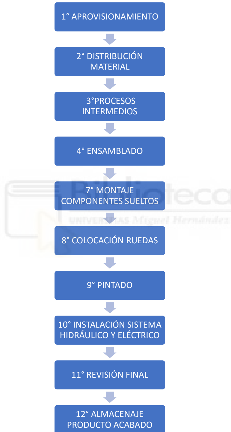
Figura 105. Secuencia de operaciones del proceso de producción del volteador
