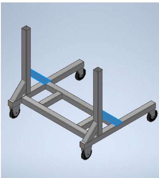
Figura 8. Perfiles estructurales cuadrados refuerzo anterior
