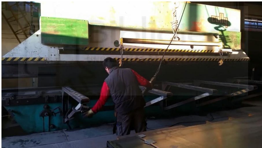
Figura 97. Plegadora Ajial de 6 metros de la planta
