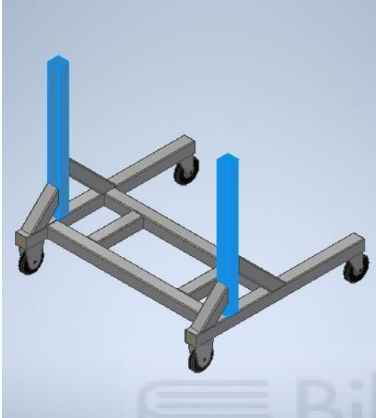
Figura 5. Perfiles estructurales cuadrados verticales
