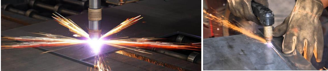
Figura 89. Corte plasma con equipos de CNC y manual respectivamente
