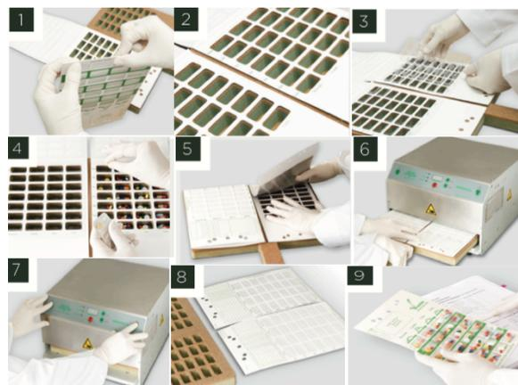
Figura 10. Procedimiento del termosellado.
