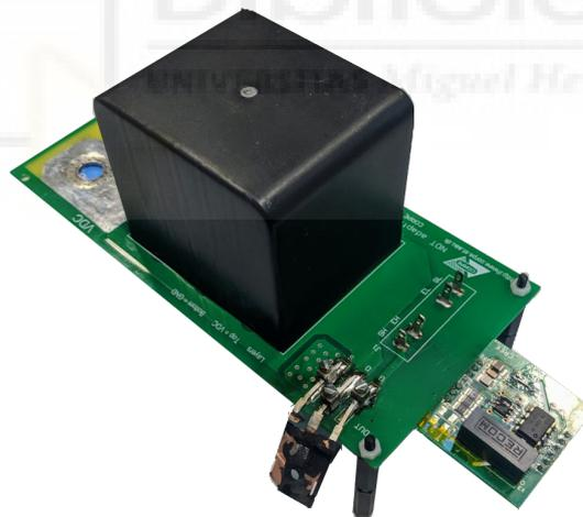
**Figura 95.** Estado del transistor C2M0080120D tras su ruptura debido a un exceso de tiempo de cortocircuito.
