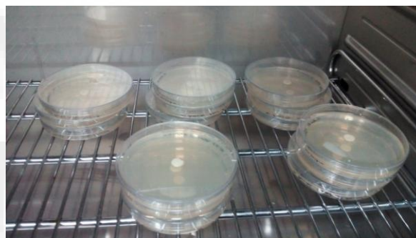
Figura 6. Incubación en disco en estufa a 37°C.
