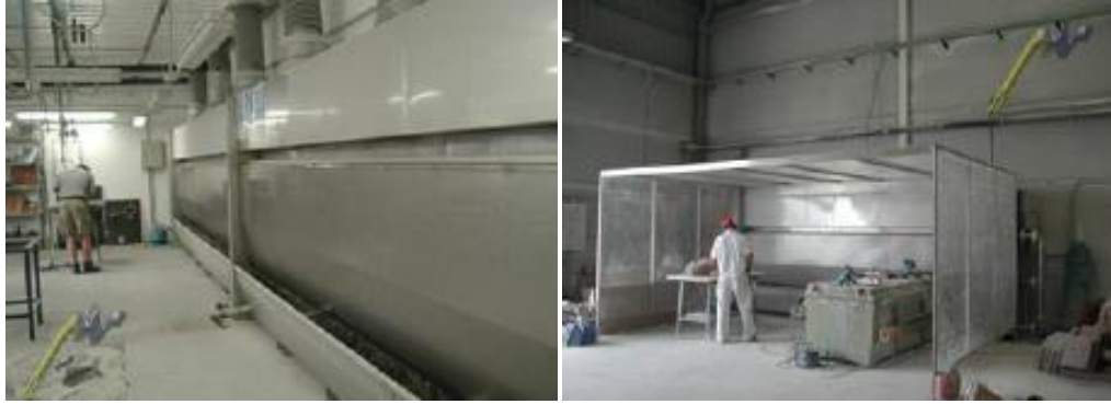
Cabinas de extracción con cortinas de agua, extraído de Grupo Tecnológico Mediterráneo, 2011 [28]
