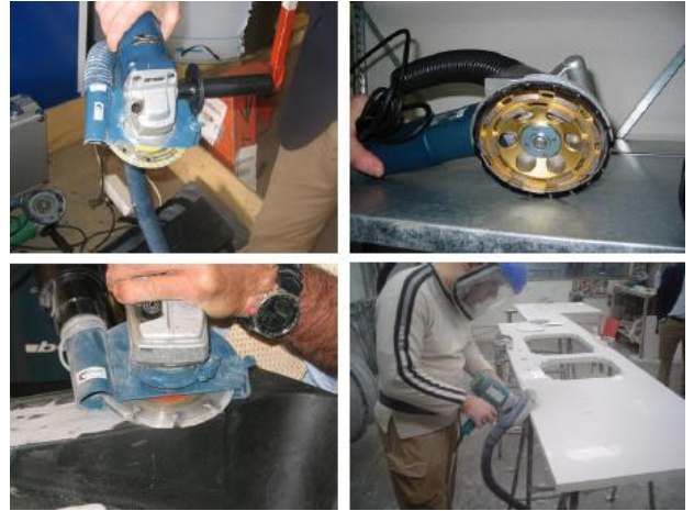
Sistemas de aspiración localizada, extraído de Barin, 2011 [28]
