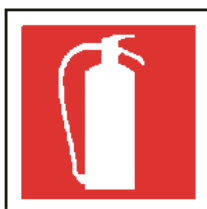
Identificación de la ubicación de extintores
