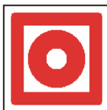
Identificación de la ubicación de Pulsador de alarma
