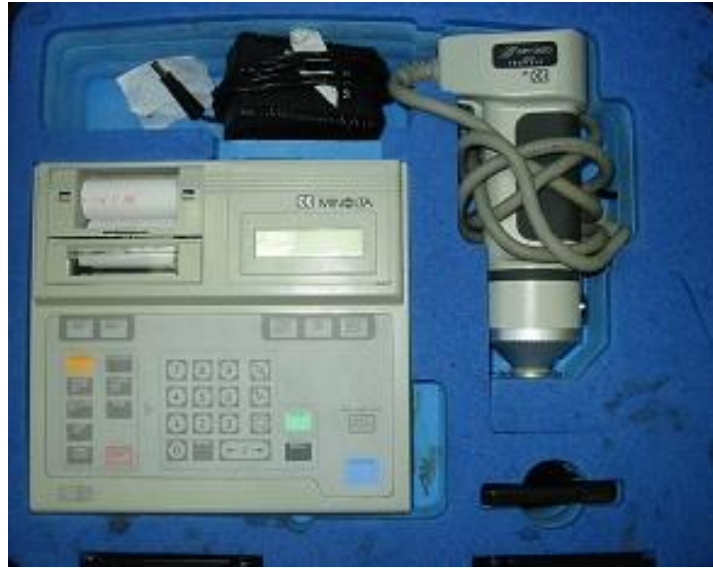
Fotografía 23: Colorímetro Minolta CR-300 utilizado para la determinación del color.
