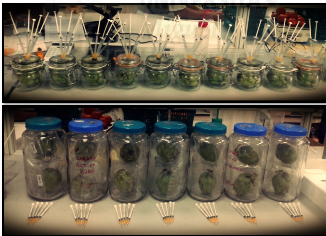
Fotografía 9: Sistema estático o cerrado de extracción de gases de los capítulos de alcachofa. Fuente: elaboración propia.
