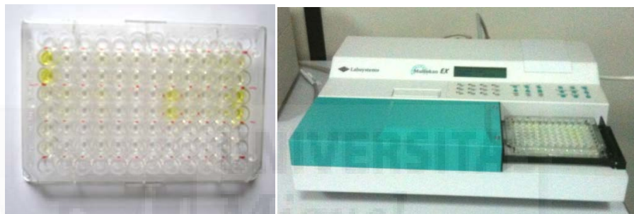
Ilustración 21: Placa ELISA con pocillos con muestra positiva coloreada y espectrofotómetro Titertek Multiskan MCC/340.
