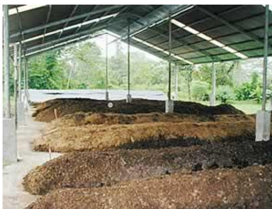
Figura 14. Sistema de compostaje en pilas abierto
