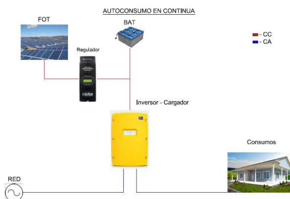
Figura 272. Sistemas interconectados separados. Generación en continua. 4.3.A.2.2.2.1 acometida único usuario y/o 4.3.A.2.2.2.2 centralización contadores.
