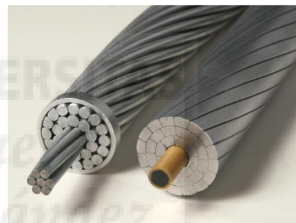
Fotografía 22. Conductor convencional y con núcleo de composite.
