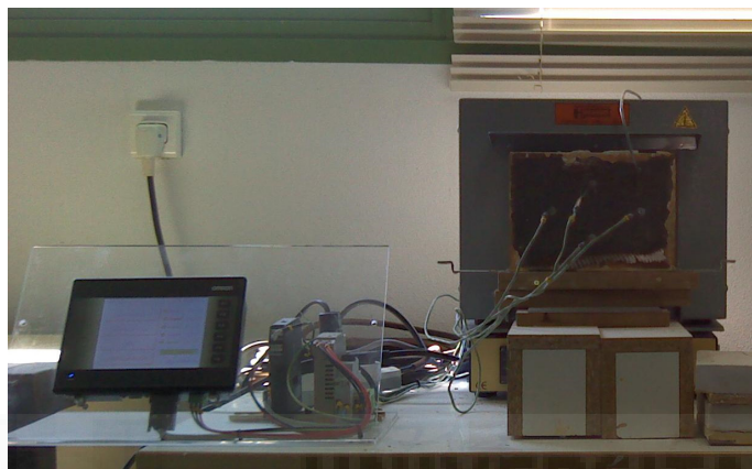
Fotografía 18: Horno mufla y datalogger con sondas.
