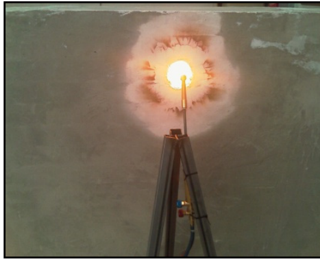
Fotografía 27: Localización del foco de calor con un soplete o llama directa. (Bomberos de Molina de Segura)
