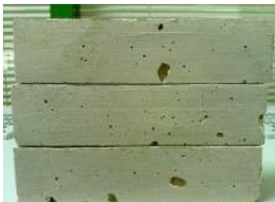
Fotografía 24: Coqueras (Burbujas de aire junto a la pared del molde). Defecto en la fabricación de las probetas de yeso. (Tesis doctoral: Berná Serna, J.M. 2013)
