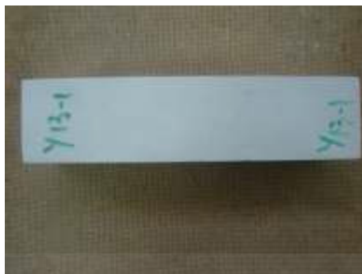
Fotografía 25: Probeta de yeso con aditivo recién desmoldada.
