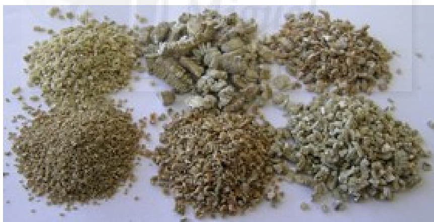
Fotografía 3: Diferentes tipos de vermiculitas en función de su granulometría. (Europerlita, S.A.)
