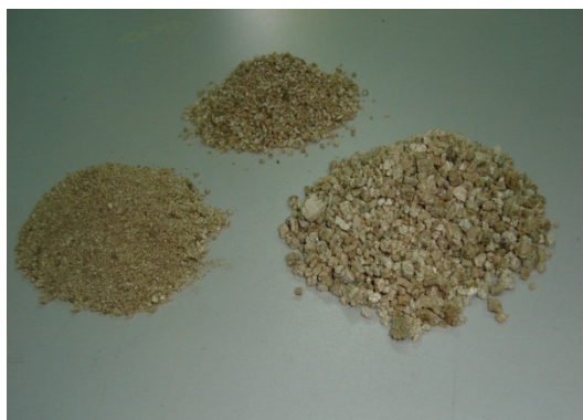
Fotografías 4 y 5: Granulometrías de Vermiculita (Tesis: Berná Serna, J.M. 2013)
