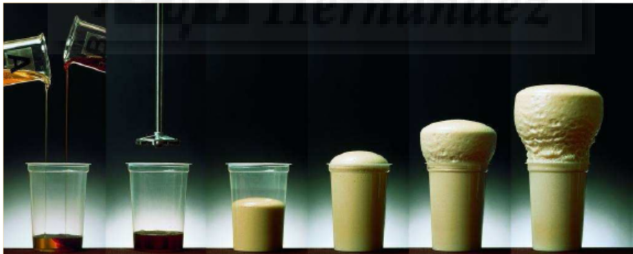
Fotografía 11: Proceso de espumación del poliuretano. (ATEPA, 2010).
