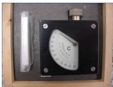
Fotografía 17: Durómetro portátil Baxlo Shore C. (Tesis doctoral: Berná Serna, J.M. 2013)
