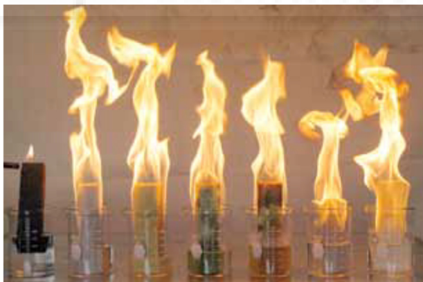
Fotografía 7: Prueba de ignición del vidrio celular. www.ayfisa.com
