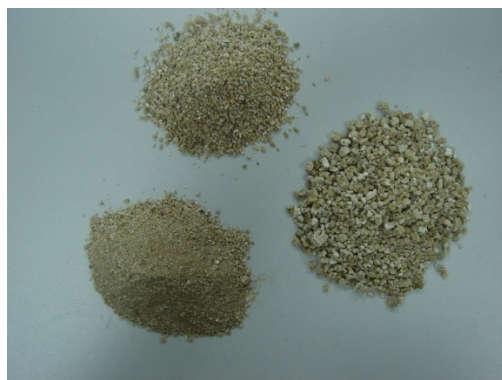
Fotografías 4 y 5: Granulometrías de Vermiculita (Tesis: Berná Serna, J.M. 2013)
