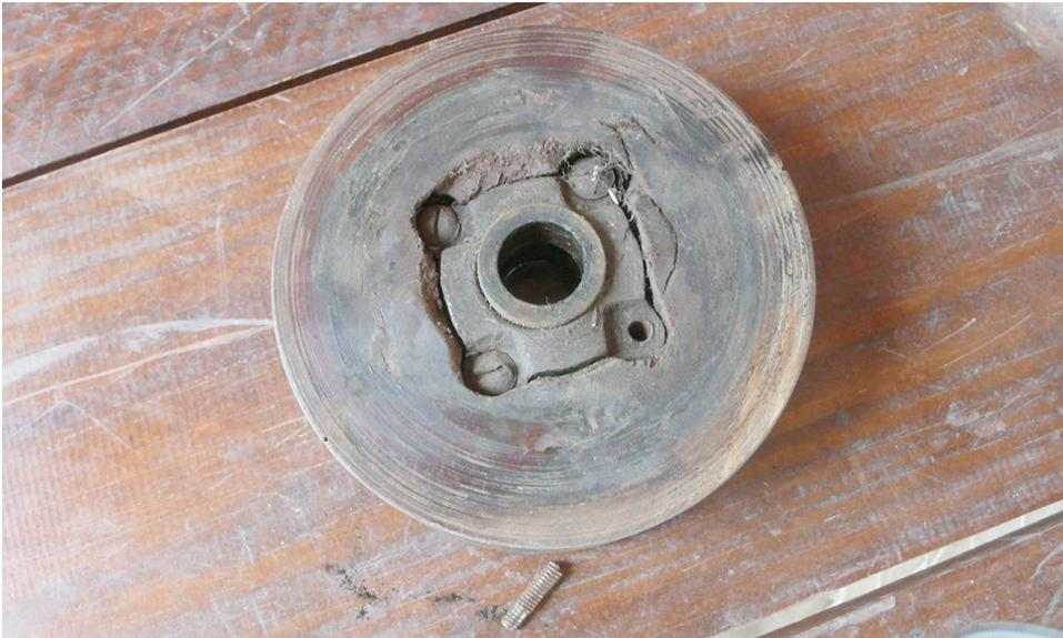
**Figura III-97:** Polea de la coronación construida en madera y un cojinete de fricción acoplado.
