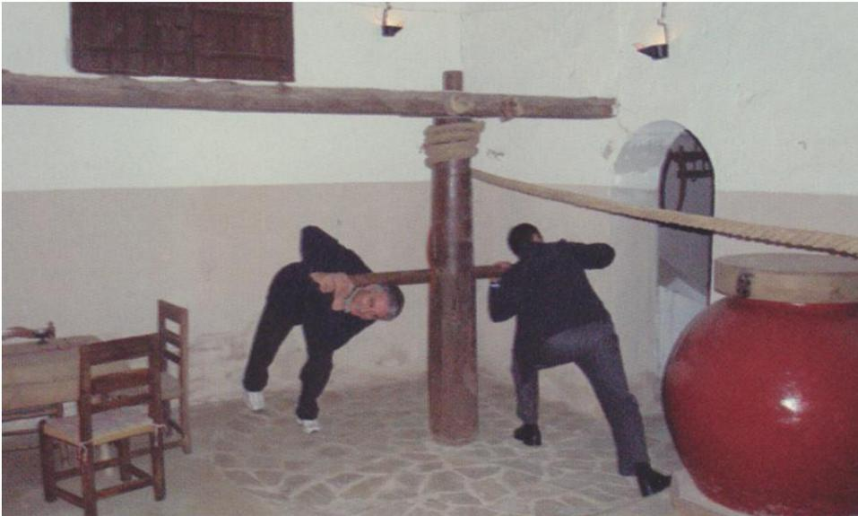
**Figura V-3:** Malacate en acción tirando de una prensa de aceite en El Conjunto Etnográfico de La Aparecida (Murcia), el sistema apoya sobre un buje dispuesto en el pavimento, y el árbol dispone de un gorrón de acero que penetra en el buje. La viga, ubicada en la cabecera, actúa de apoyo al gorrón superior. Foto sacada de la revista *El Setiet*.
