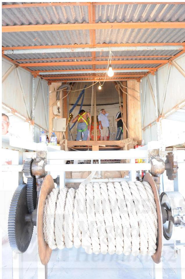
**Figura III-85:** Fotografía efectuada desde la parte trasera del torno grande, al fondo se ven los pilares de la cabria donde se puede ver la trayectoria de la maroma así como el tambor del torno grande con la maroma arrollada.
