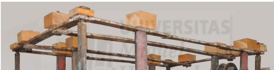
**Figura IV-16:** Marco superior del bastidor. A en los vértices se aprecia el recrecido de la pletina y la unión muesca espiga de los pilares principales, en primer plano la U trasera que compone el marco y el trozo recto del lado izquierdo que lo une a la U de la parte frontal. Entre lados largos del marco los dos largueros y los dos grupos de pilares secundarios. Para mantenerlo sujeto se les coloco a las espigas y pernos un taco de madera que supliese a la caja que lo contenía.
