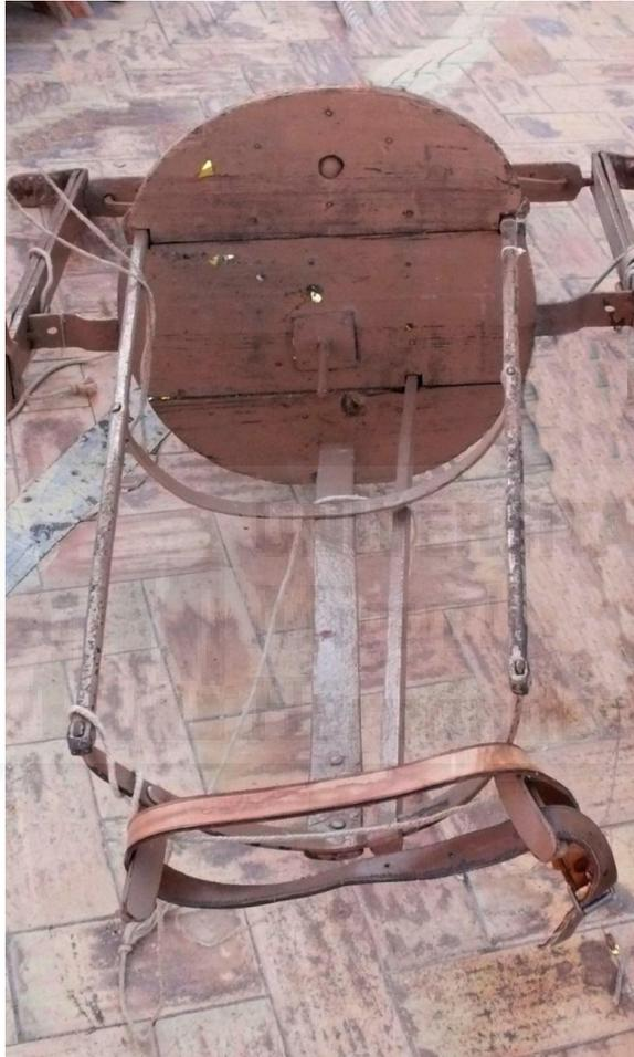
**Figura III-207:** Parte superior de los pilares que forman el sitio central con los dos arcos de elipse que los cierran y el cinturón de seguridad del arnés.
