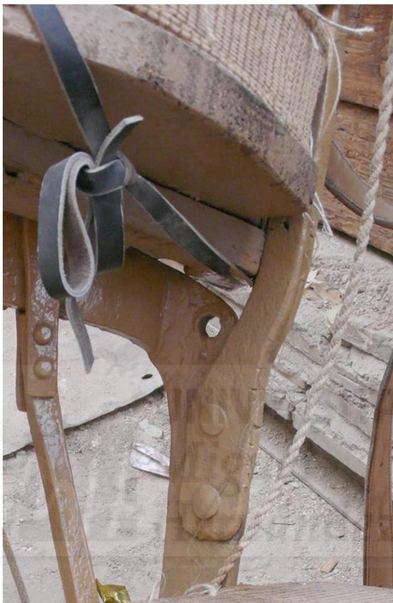
**Figura III-244:** Un punto de sujeción entre el arco de suspensión y el bastidor principal.
