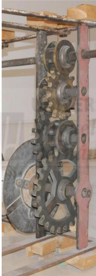
**Figura IV-22:** Cadena cinemática del torno grande. Del exterior al interior se puede ver en primer lugar la columna secundaria externa del lado izquierdo, a continuación los engranajes con sus arboles y le sigue la columna secundaria central. La primera está construida en acero laminado, la central en forja. Los extremos de las externas se sujetan en los marcos y las intermedia a los travesaños.
