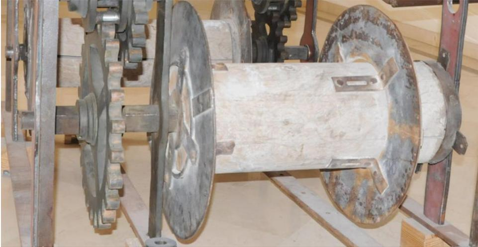
**Figura IV-29:** Tambor de salida del torno grande visto desde la parte lateral izquierda.
