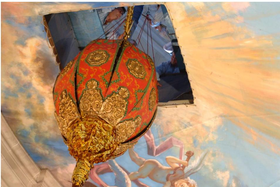
**Figura III-155:** La *mangrana* entrando en escena. La puertas del cielo están abiertas y sobre la plataforma se ven a los tramoyistas en tendido prono sobre las tablas de trabajo controlando el paso del aparato por el hueco.
