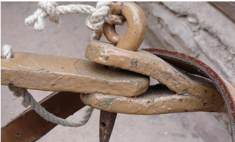
**Figura III-239:** Horquilla de sujeción, con la clavija de sujeción, de la pieza móvil del octágono.
