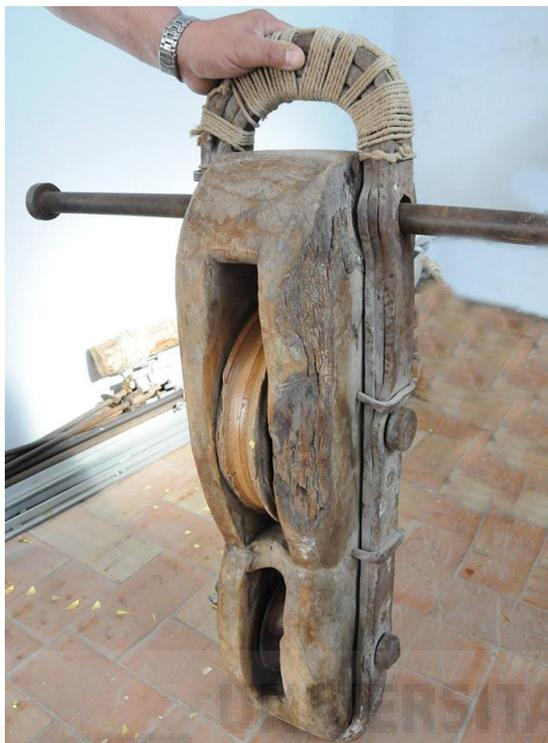
**Figura III-96:** Poleas del vértice de la cabria montadas en su armadura.
