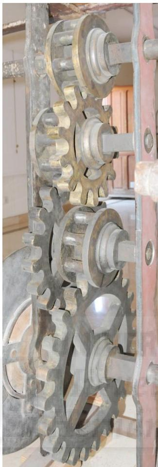
**Figura IV-32:** cadena de engranajes del torno grande.
