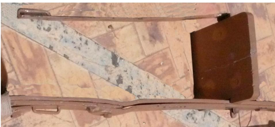
**Figura III-214:** Sitial central con la pletina destinada a la sujeción del ocupante. En el extremo se ve la anilla que se corresponde con la existente en la rama de la parábola del bastidor para pasar el cinturón de sujeción.
