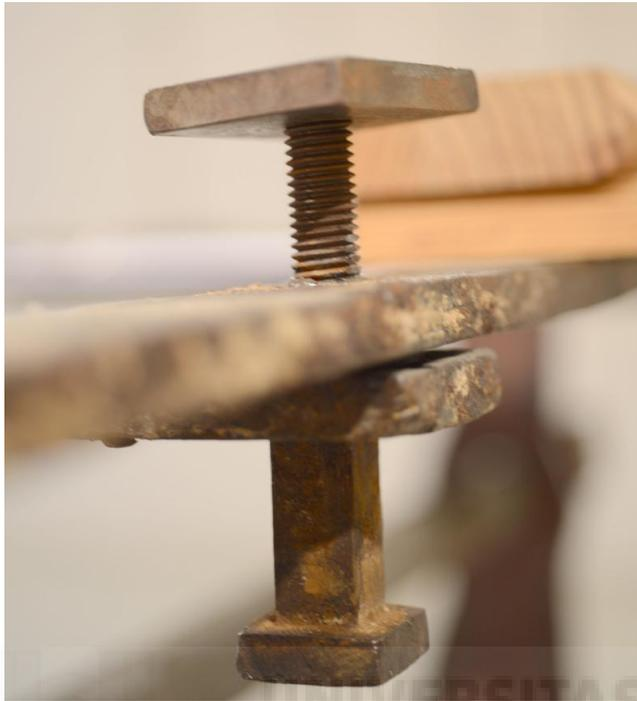
**Figura IV-19:** Perno de unión al lado corto que forman las U de uno de los travesaños.
