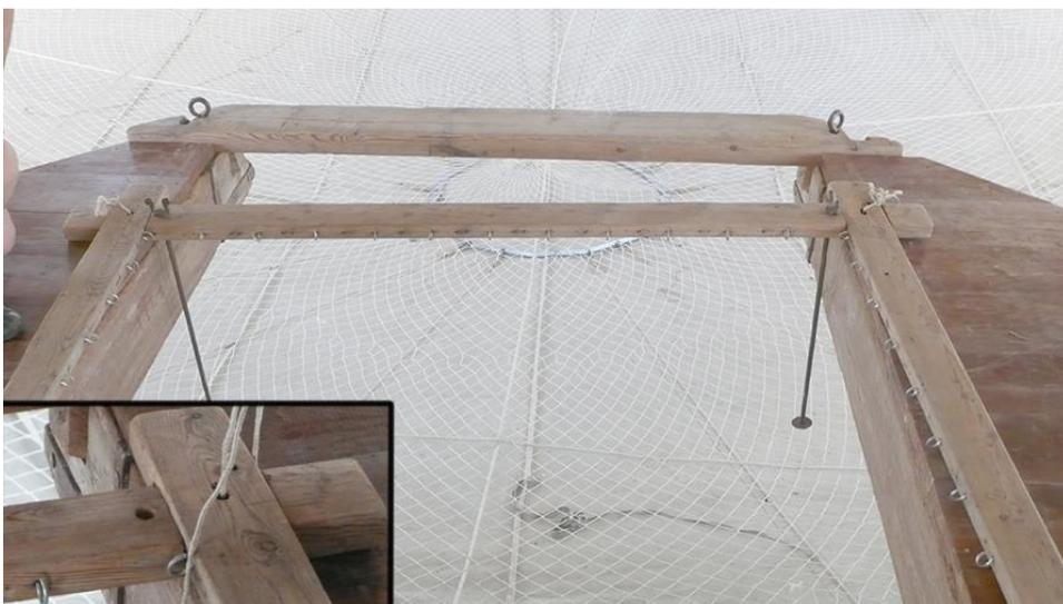
**Figura III-143:** Fotografía del bastidor de sujeción del lienzo junto con un detalle de la unión de los vértices.
