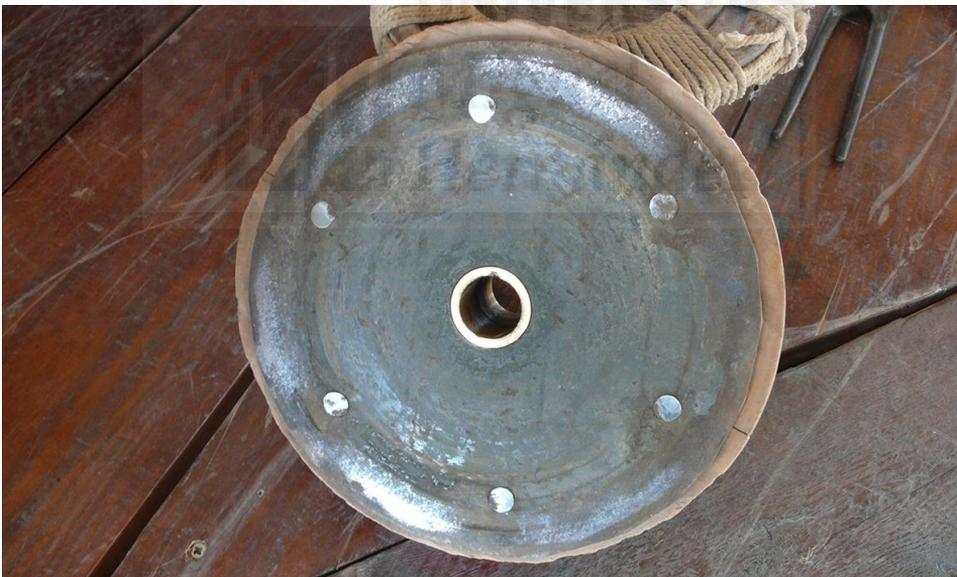
**Figura III-98:** Polea de la *mangrana* y el *Araceli* construida en madera, reforzada con dos discos de acero de refuerzo remachados entre si y un cojinete de fricción acoplado.
