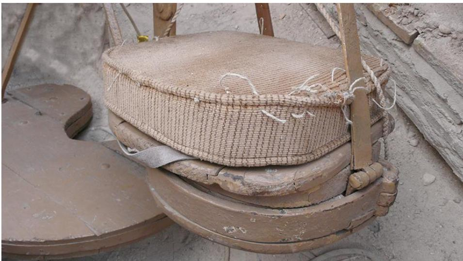
**Figura III-233:** Vista trasera del sitial lateral izquierdo con la madera y la almohadilla. En primer plano el arco de circunferencia formado por la pletina, al final de este la articulación del cierre del puente delantero y por encima de este la articulación del arnés de seguridad.
