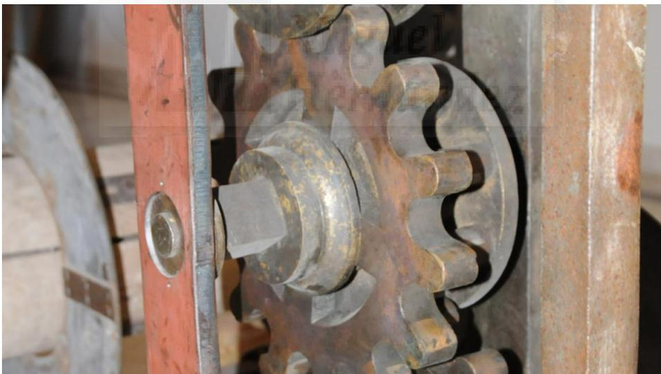
**Figura IV-12:** Pieza de bronce con el color salmo típico que adquiere tras haber sido expuesto a una alta temperatura, en este caso inferior a la de fusión, y posterior enfriamiento. Hay que tener presente que, posterior al proceso de fusión llevado a cabo en su fabricación, fueron torneados y el color salmón original desapareció con el mecanizado.
