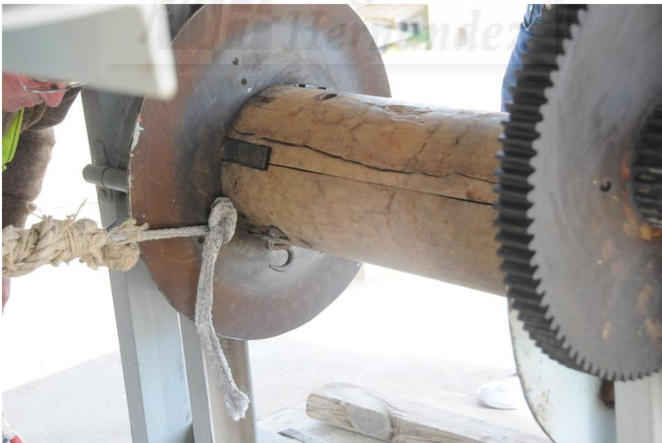
**Figura III-115:** Fotografía del tambor en el que se puede ver el gancho de sujeción de la maroma así como el alma de la maroma sujeta a un punto adicional al gancho. A la izquierda del alma se ve la composición de cáñamo.
