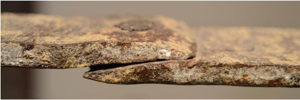
**Figura IV-17:** Una de las uniones de la U con el tramo recto en el marco superior.
