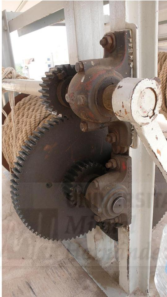
**Figura III-109:** Fotografía de la cadena cinemática del torno pequeño. En primer plano la sujeción de la cigüeña al árbol de entrada, le sigue dos de los soportes de pie sujetos a un pilar: el de arriba, correspondiente al árbol de entrada y debajo a uno de los engranes intermedios; detrás del soporte del árbol de entrada se ve el piñón y el árbol de entrada.
