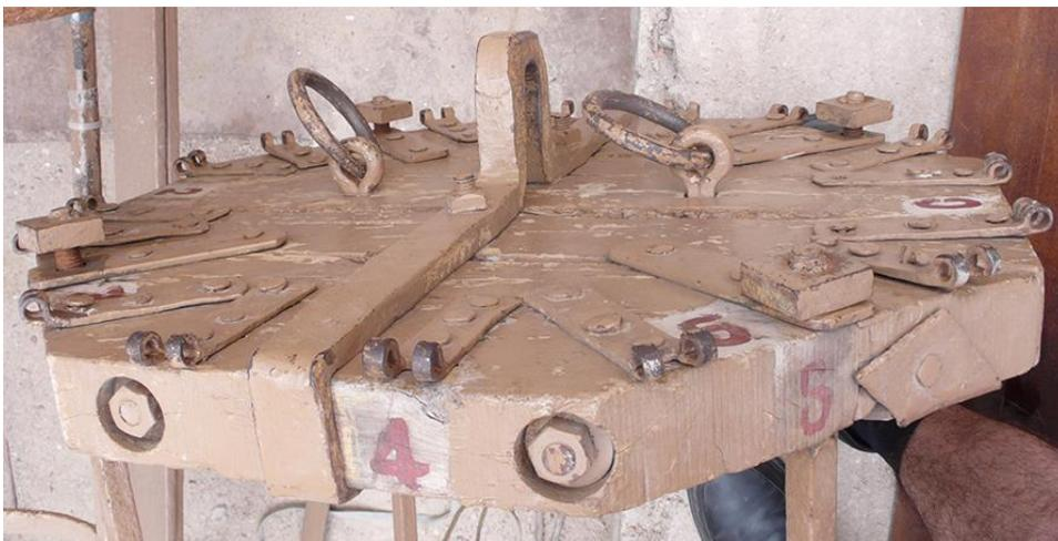
**Figura III-162:** Vista superior del prisma de cubierta, se pueden ver con detalle: el puente de sujeción, los cáncamos con la argolla, las bisagras, las tuercas de sujeción de los pilares y los refuerzos del punto de sujeción de pilares y el refuerzo de las tablas.
