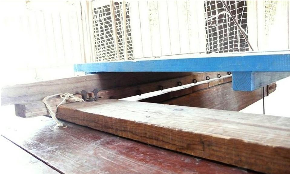
**Figura III-146:** Fotografía del como queda el bastidor de tablas pegado a la plataforma y una de las tablas apoyada en la guía sur.
