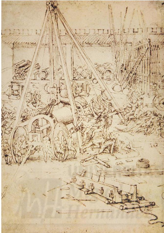
**Figura V-15:** Dibujo realizado por Leonardo Da Vinci titulado: *El Arsenal*. En él se puede ver una cabria compuesta por cuatro pilares y entre cada dos laterales dispone de un torno apoyado en los pilares con cuatro grupo de palancas y accionado cada torno por dieciséis personas.
