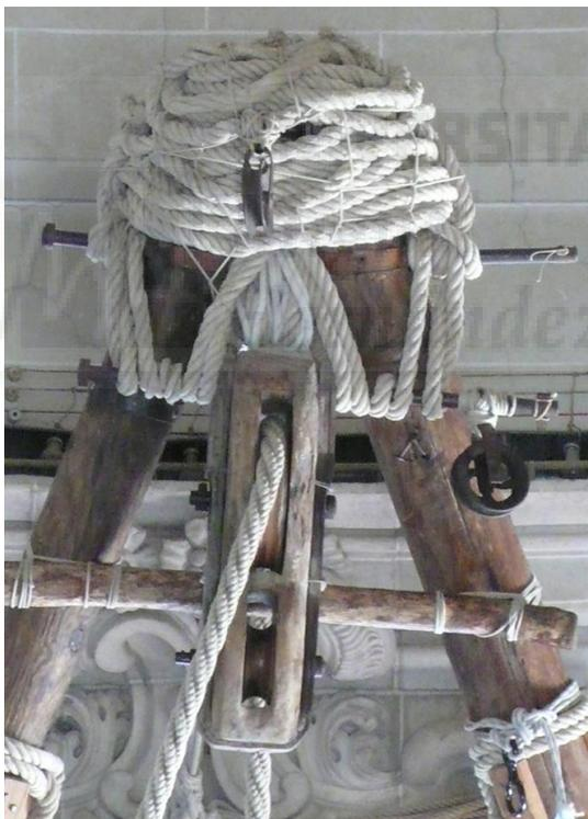
**Figura III.93:** Fotografía de la cabecera de la cabria como se unía antes de colocarle los herrajes, en ella podemos ver la polea de suspensión la de compensación de fuerzas pasivas y en el centro a la izquierda la utilizada para la apertura y cierre de las alas de la *mangrana*
