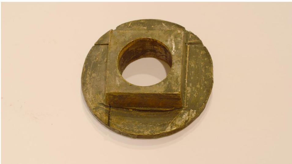
**Figura IV.23:** Buje original compuesto de valona y la parte exterior del casquillo mecanizada con forma cuadrada.
