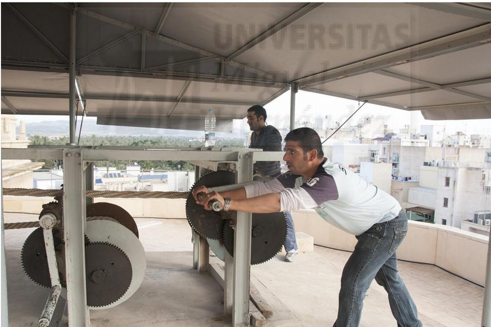
**Figura III-114:** Fotografía del torno grande en acción, en primer plano, tras los pilares, están los engranes acoplados al árbol de los tambores de salida. En la parte superior se ve la caseta.
