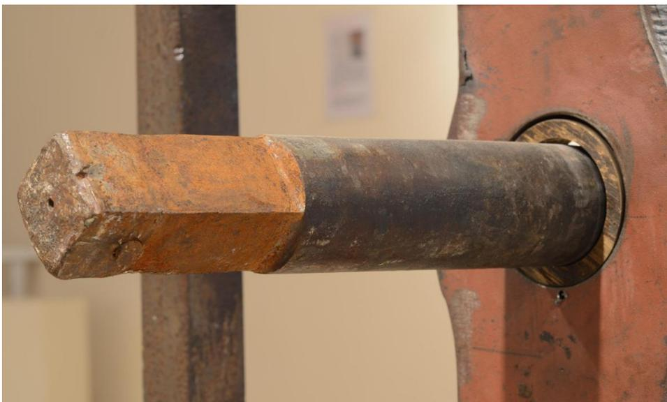
**Figura IV-26:** Extremo de uno de los árboles de entrada mecanizado con forma cuadrada para albergar a su correspondiente cigüeña. A continuación el gorrón albergado en el cojinete de fricción.
