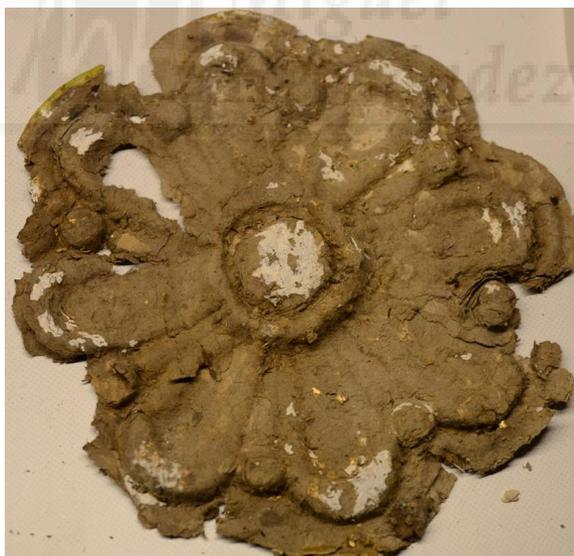
**Figura III-173:** Estado del rosetón tras la retirada de todo el maquillaje. Parte de papel maché.
