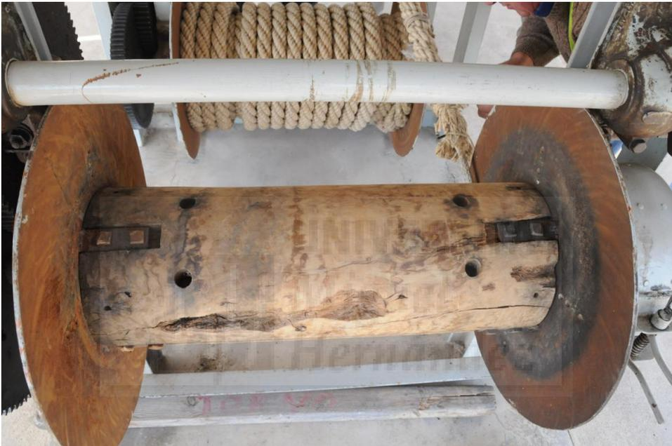
**Figura III-113:** Fotografía del tambor de salida correspondiente al torno grande. En los laterales se ven los delimitadores con las escuadras y los tornillos de sujeción; en el centro la matriz construida con madera en la que se encuentran los orificios de alojamiento de los tornillos de sujeción de la matriz al árbol.
