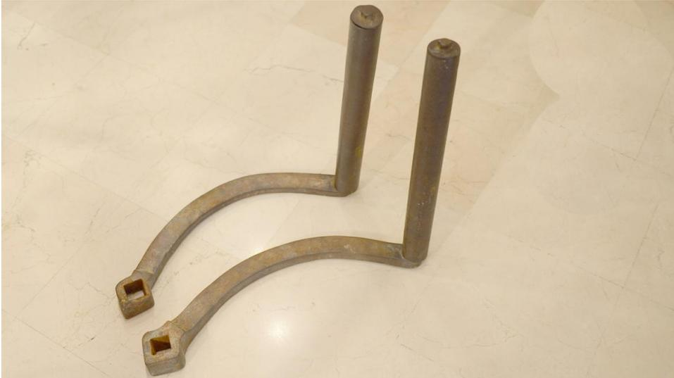
**Figura IV-25:** Pareja de cigüeñas. En las empuñaduras se aprecia el cilindro bloqueado con la tuerca y arandela, en el extremo opuesto se ve la muesca cuadrada para ensamblar con el extremo del árbol.
