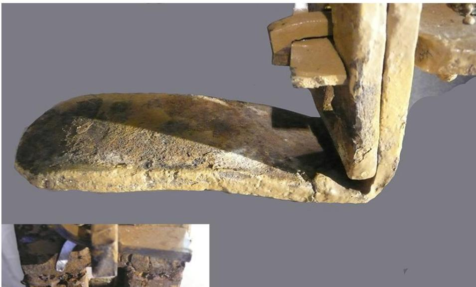
**Figura III-194:** Terminación de los ramales. El interior forma el ángulo y el exterior lo hace en la línea que forma el vértice. Encima del vértice se puede ver una espiga, del travesaño de cierre, metida en su muesca con la cuña de bloqueo. El detalle adjunto muestra la cuña de bloqueo.
