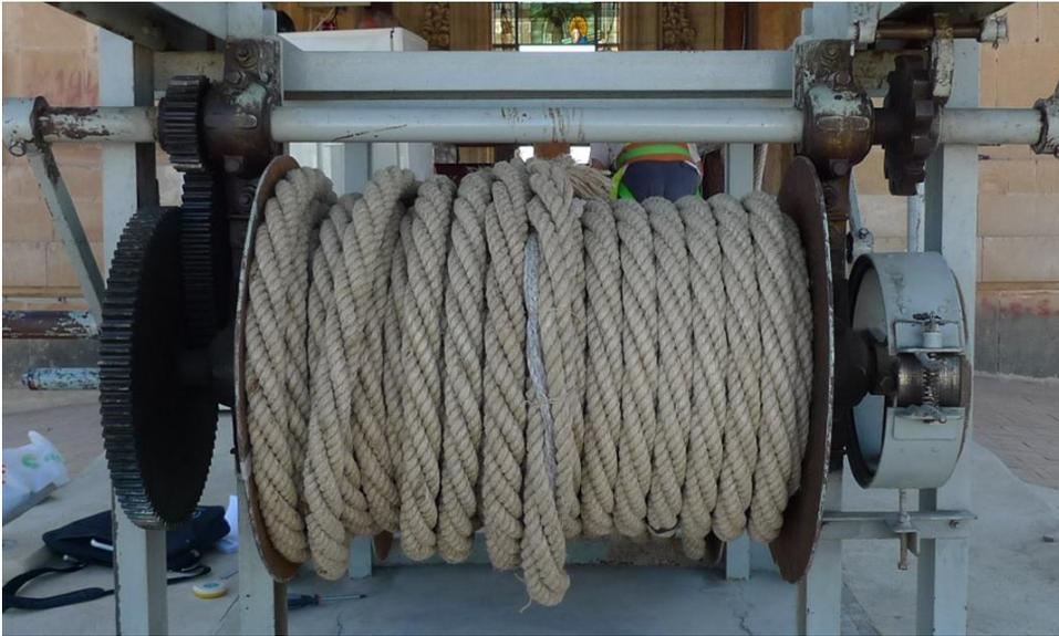
**Figura III-86.** Fotografía de la maroma de elevación de los aparatos grandes arrollada al tambor del torno.
