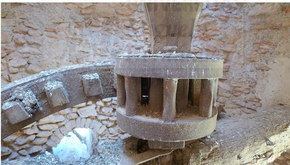
**Figura IV-34:** sistema de engrane, perteneciente a un molino de viento de la época del crecimiento de Cartagena, que está formado por una rueda de madera con dientes de madera y una linterna con cilindros de acero sujetos a discos de madera reforzados con cinchos de acero y sujeta a una árbol de madera.
