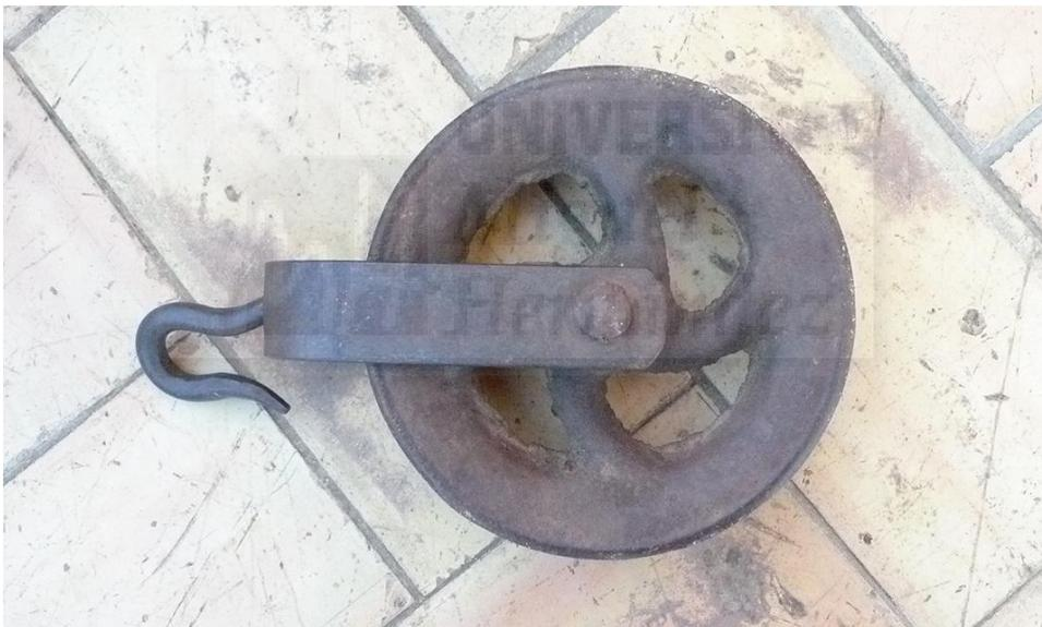
**Figura III-100:** Fotografía de la polea de compensación de fuerza y apertura y cierre de la mangrana. Foto del autor.
