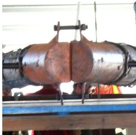
**Figura III-136:** Vértice sujeto entre sí.
