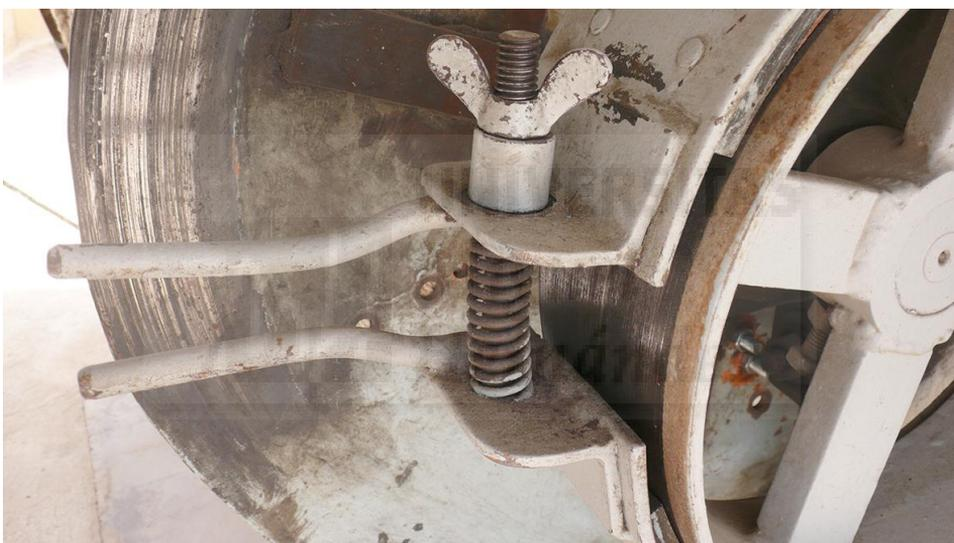
**Figura III-118:** Fotografía del sistema de accionamiento del freno.
