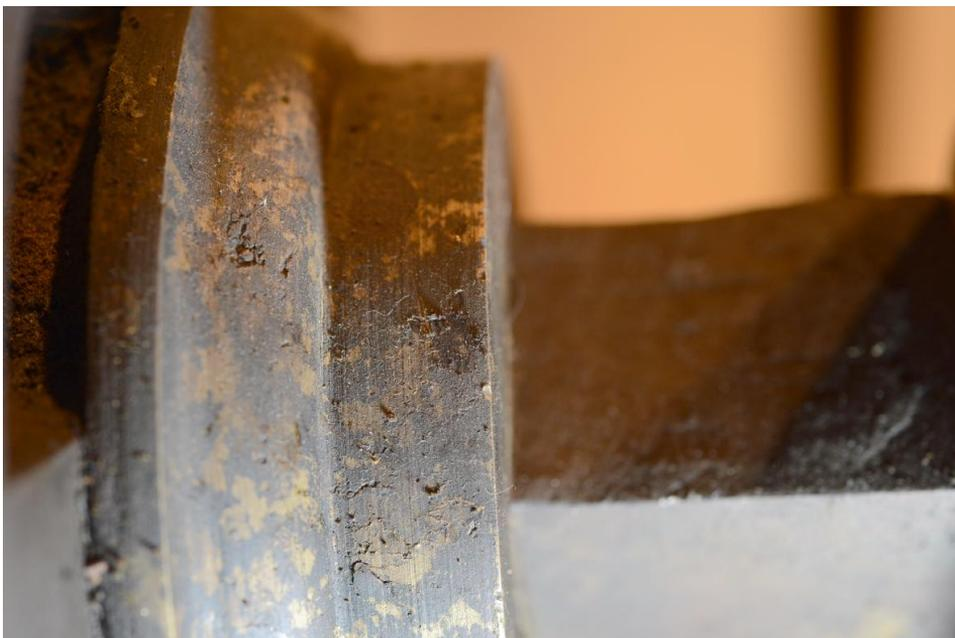
**Figura IV-11:** Superficie de una pieza de bronce cubierta de hollín y que pertenece al tren de engranajes del torno pequeño, el más próximo a la ventana.
