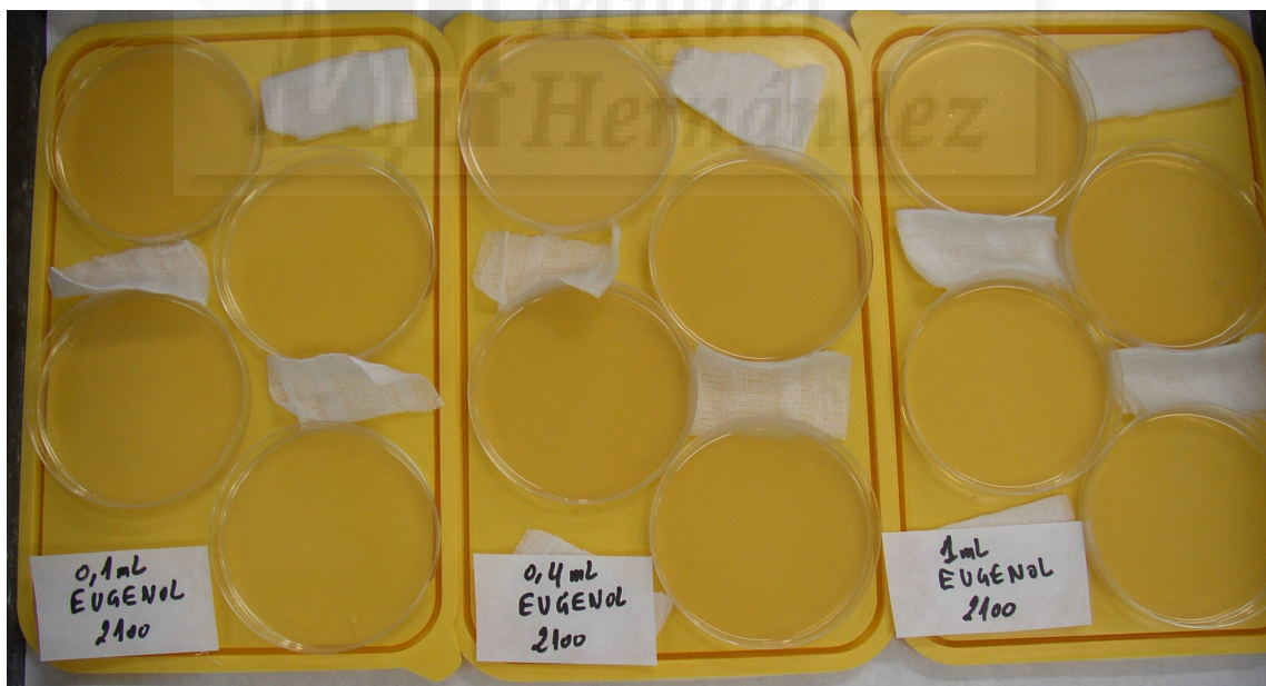
Fotografía 22. Placas Petri sembradas con Botrytis cinerea y tratadas con eugenol (0.1, 0.4 y 1 mL) tras 7 días a 30°C.
