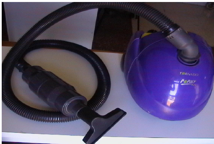
Figura 11. Aspiradora modificada utilizada para recoger muestras de polvo
