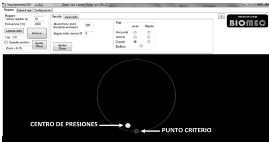
Figura 5. Imagen del software proyectado frente al participante para proporcionar información visual del desplazamiento del centro de presiones (blanco) y para retar la capacidad de éste de ajustar la posición de su centro de presiones a un punto criterio (gris) que permanecía estático o se desplazaba describiendo diferentes trayectorias. En esta imagen el participante intentaba seguir el punto rojo a lo largo de una trayectoria circular. Aunque la trayectoria se presenta en la figura mediante una línea roja para que el lector la identifique claramente, no era presentada durante el estudio para dificultar la labor de los participantes.
