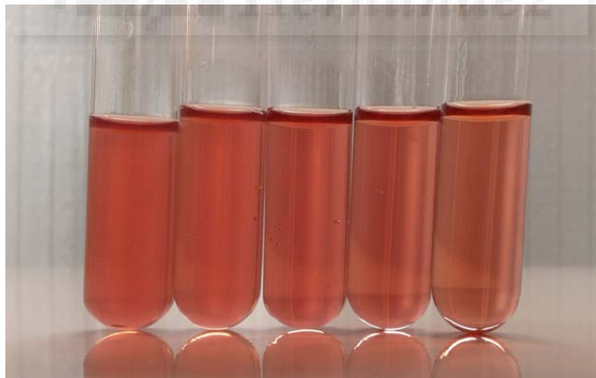
Imagen 13. Zumo de granada clarificado con bentonita sódica (0.1 → 2 g/L) y pasteurizado a 65 °C 30 s
