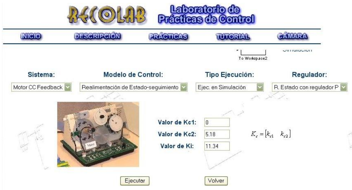
Figura 5.57. Datos del regulador del control en el espacio de estados con seguimiento de la salida en simulación del servomotor de CC
