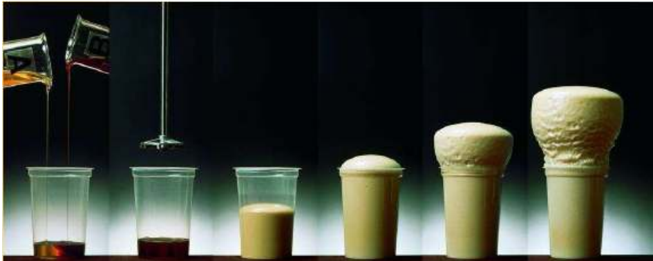
Fotografía 20: Proceso de espumación del poliuretano. (Fuente: (55) ATEPA, 2010).
