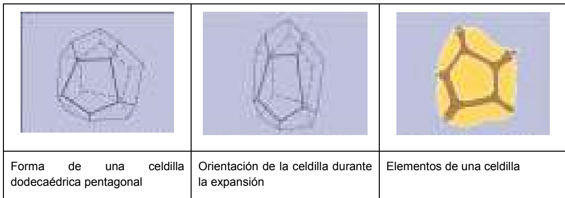
Figura 18: Estructura de una celdilla de espuma. (Fuente: (100) Bayer Material Science. Información técnica, 2004).
