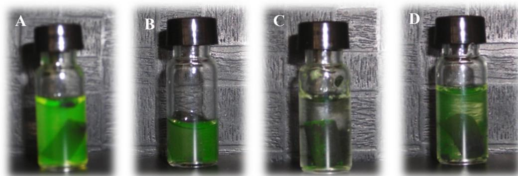
**Figura 48.** Análisis de la unión de CLyt-GFP a los andamios de MWCNTs funcionalizados con DEAE. A: incubación de CLyt-GFP con el andamio (a tiempo cero); B: proteína no retenida en el andamio (después de 10 min); C: andamio de (A) en presencia de 1 M NaCl (10 min); D: andamio de (C) en colina 2 % (p/v) (10 min).
