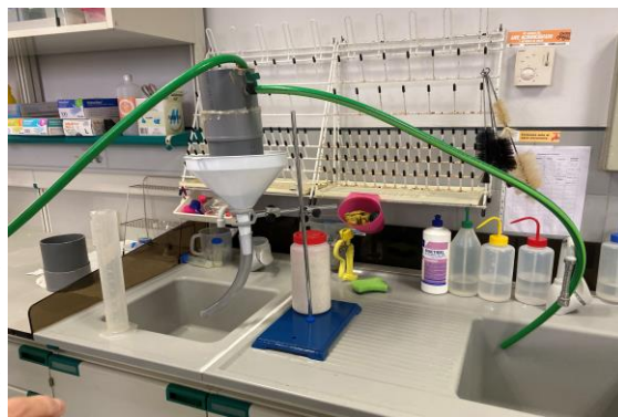
Figura 6. Ensayo de K_{hs} .
