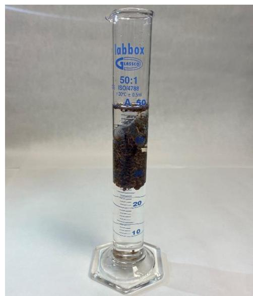
**Imágenes 3 y 4.** Medida de densidad real mediante método modificado de picnómetro.
